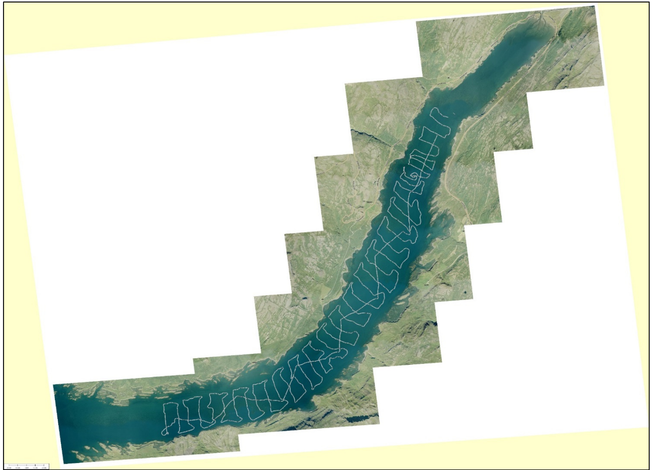
11. mynd. Leiðarlínur slöngubáts við bergmálsmælingar í Þorskafirði í frumathugun Hafrannsóknastofnunar í ágúst 2015. Sigt var á 4 -5 sjm. hraða og heildarlengd sniða var u.þ.b. 34 sjm. eða 65 km.
