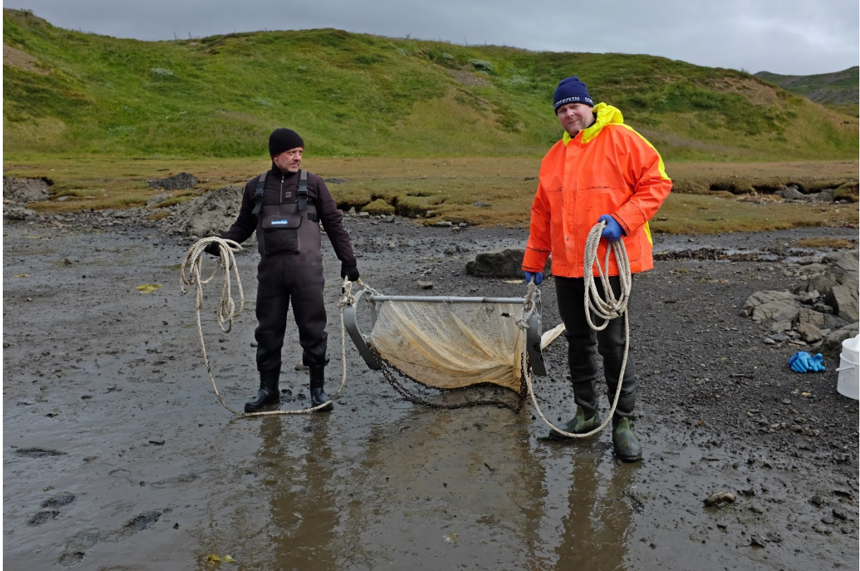
5. mynd. Bjálgatrollið sem notað var við sýnatökur í Þorskafirði, Djúpafirði og Gufufirði í frumathugun Hafrannsóknastofnunar í ágúst 2015 (ljósm. Hjalti Karlsson).
